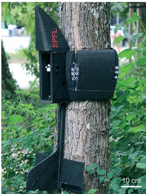
Рис. 3. Робот с обнимающими крыльями [62]
